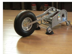
重量床衝撃音測定風景
